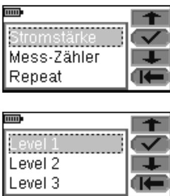
Abbildung 11: Einstellen des Messstromes
